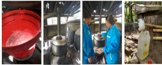
Gambar 1. a) Wadah Penampung Air Lontar, b). Tungku Penyulingan Moke arak , c). Proses Penyulingan, d). Penampungan Moke Arak Hasil Penyulingan.
