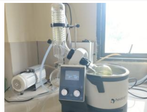
Gambar 4. Pemisahan Pelarut dengan Rotary Evaporator
