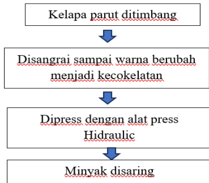
Gambar 1. Diagram alir ekstraksi metode kering (P1)
