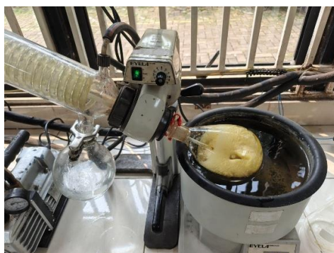
Gambar 1. Proses Rotary Ekstrak Lerak
