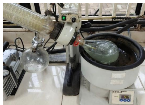
Gambar 2. Proses Rotary Ekstrak Lidah Buaya
