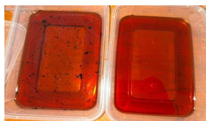
Gambar 2. Asap cair kulit buah kakao hasil ekstraksi pirolisis: (a) asap cair yang masih mengandung tar, (b) asap cair yang telah dimurnikan
