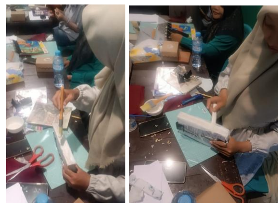
Gambar 7. Kegiatan melapisi lem dan menempelkan kain kasa pada punggung buku
