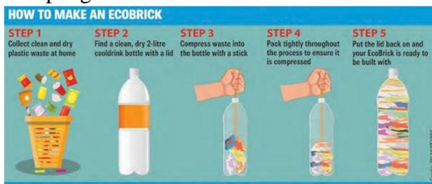
Gambar 4. Proses pembuatan Ecobrick
